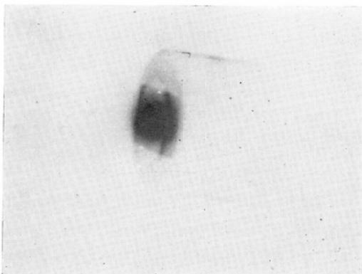
FPD70cm, 70KVp, 200mAs, Pinhole 直径 0.3 mm拡大等倍
