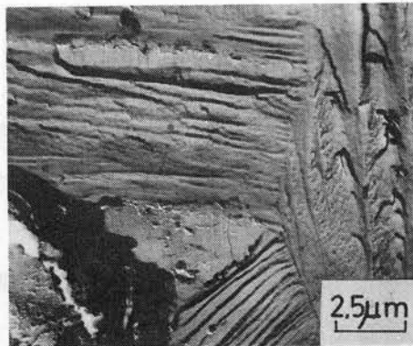
写真 3-6 AZ 31 合金のき裂伝ば遷移域における破面
