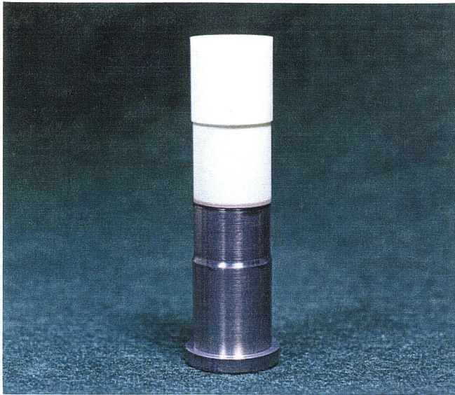
図5.10 試作完了部分モデル ( O_2 分離管)
