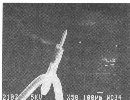
図2-15 熱電界放射型電子銃用Zr-W(100)陰極チップ。Wフィラメントに、
