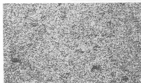
(b) 50ニッケル・50クロム溶射皮膜
