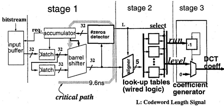
Fig. 3.10 可変長符号復号化器の構成
