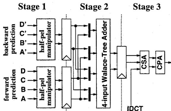
Fig. 3.20 パイプライン画素生成部の構成
