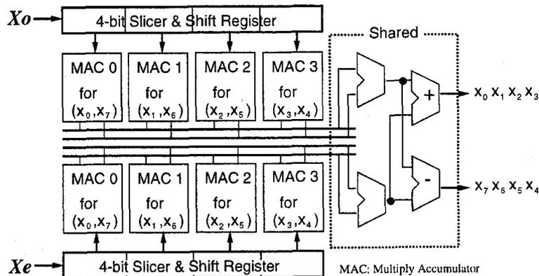
Fig. 3.17 逆離散コサイン変換器の構成
