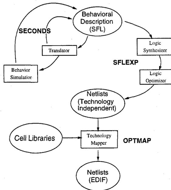
Fig. 2.3 PARTHENON による設計フロー
