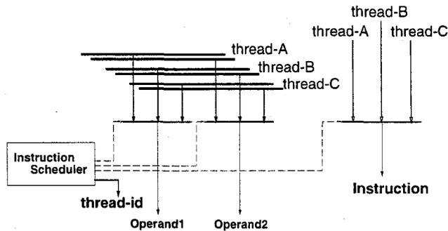
Fig. 2.13 命令選択ユニットのブロック図
