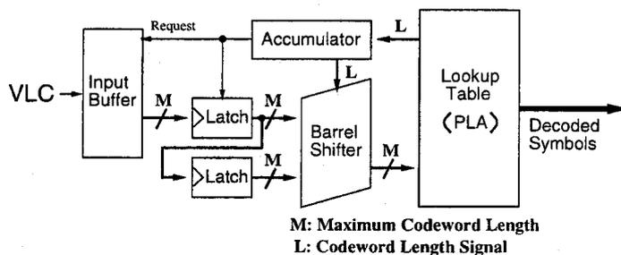
Fig. 3.9 従来の可変長符号復号化器の構成
