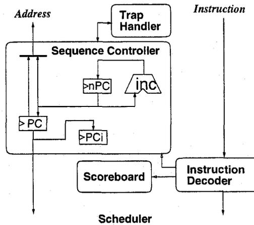
Fig. 2.9 命令解読ユニットのブロック図
