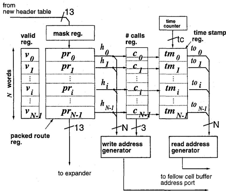
Fig. 5.2 セル組み替え制御部の構成
