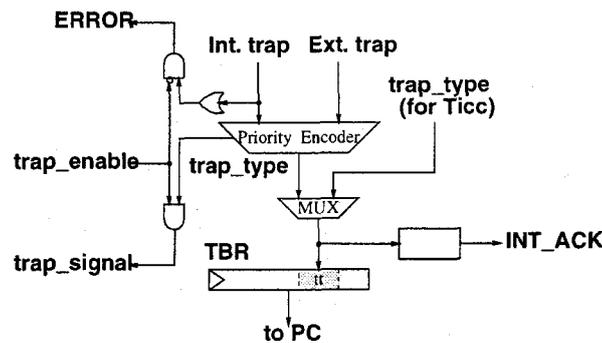
Fig. 2.11 割り込み検出部の構成
