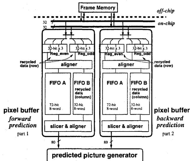
Fig. 3.26 ピクセル I/O バッファの構成
