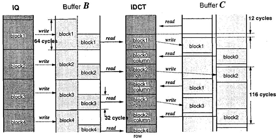
Fig. 3.24 Buffer B および C の書き込み/読み出しタイムチャート
