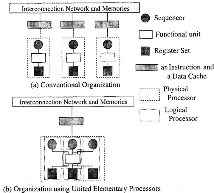
Fig. 2.2 マルチプロセッサシステムの構成
