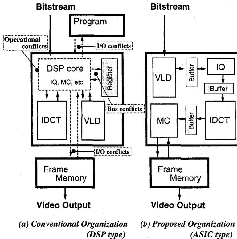
Fig. 3.8 MPEG2 デコーダの実装手法
