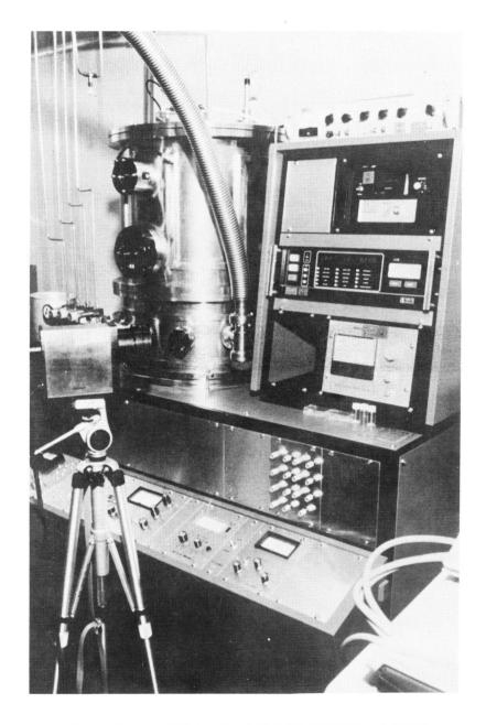
第2-2図 本研究で用いた酸化錫超微粒子膜の作製装置
