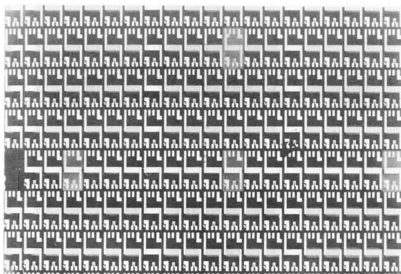
第5-4図 ウエハー状態の集積化超微粒子膜ガスセンサ
