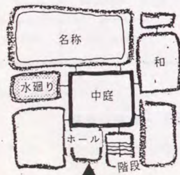
図-6.60 「中庭+前階段+後方水廻り」型のダイアグラム
