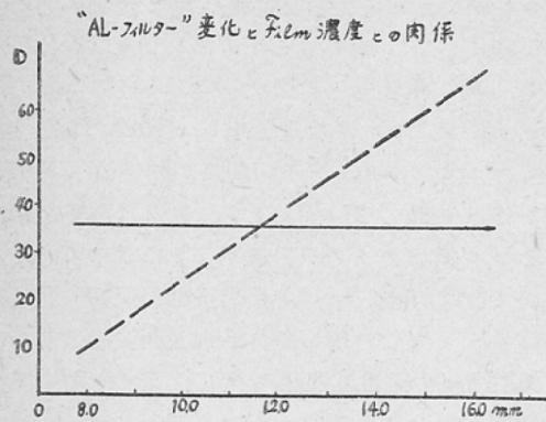
フルスケールとしたものである。此れを黒化度に直して見るとホトタイマー使用の際の黒化度差は僅か0.01に過ぎない。破線で示した曲線は電圧、電流、時間を一定にして(76KV, 60mA, 1sec)フィルターの厚さを同様に変化させた場合で、これの黒化度差は0.75である。
