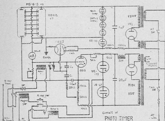
りマヂツクアイ(6E5)のグリッドに誘導して、是の螢光面を變化させる。螢光面はスイッチの閉じることによつて開眼より閉眼に移り、完全に閉じた時露出が終る様になる。以上が本装置動作の概要である。
