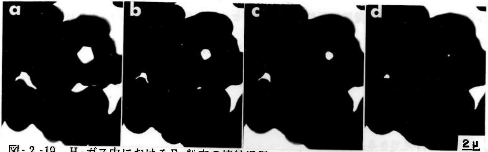
図-2-19. H_2 ガス中におけるFe粉末の焼結過程. ガス圧; 1気圧, 温度; 室温~1273K
