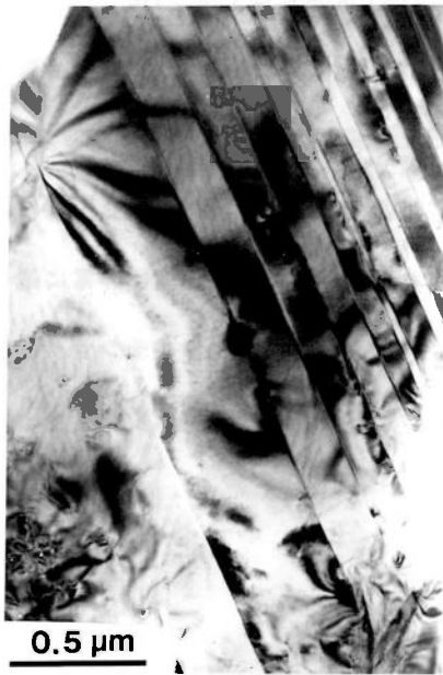
図-5-14. 純 ZrO_2 の単斜晶相(m相)に頻度よく見られる双晶組織の電顕写真.
