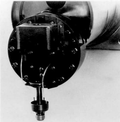
図-2-2. 万能雰囲気カプセルの外観写真。 試料交換はエアロックシステム により簡便に行なうことができる。
