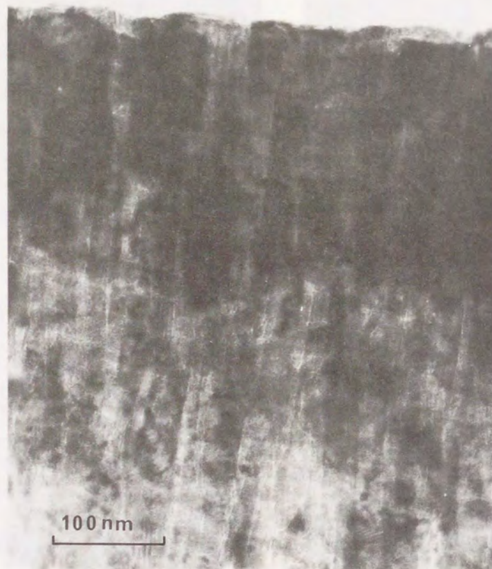
図 4-4 TiN にみられる成長した柱状晶
