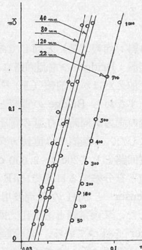
図4 電極間距離による Resistance の変化(I)
