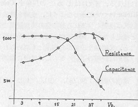
図8 印加電圧を高めた時の Impedance の時間的変化、および矩形低周波脈流通前後の時間的変化
