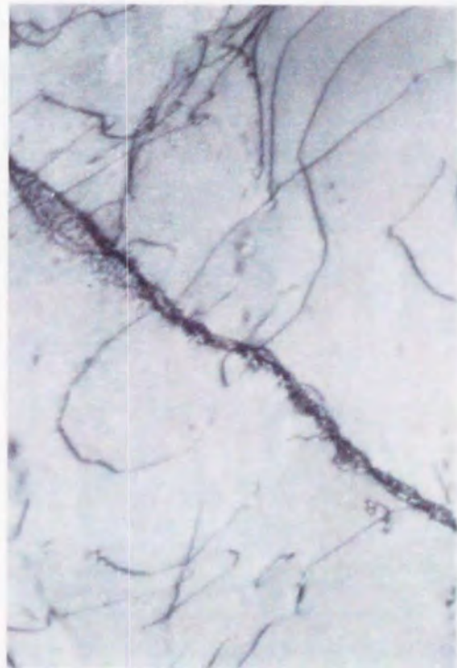
Fig.5-29. TEMによる組織観察写真 ( t/t_f=0.38 , 連続試験法, 応力: 100MPa, 温度: 973K).
