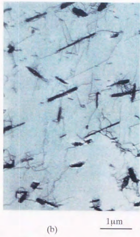
Fig.4- 40. TEMによる組織観察写真 ( t/t_r=0.60 , 連続試験法, 応力: 45MPa, 温度: 923K).
