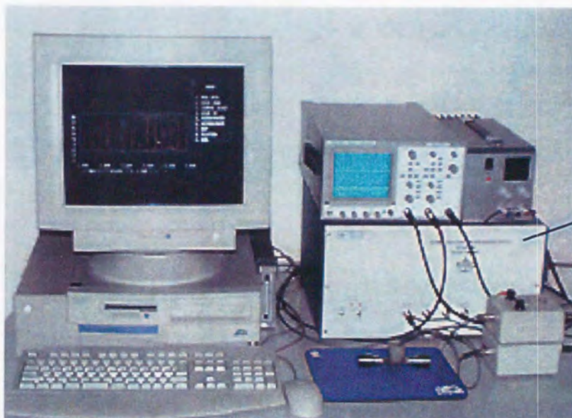
Fig.2-6. EMAR 計測システム.
