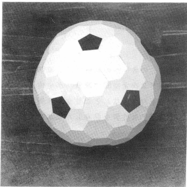
図表 3-2-22 正 600胞体の 1/3タイプの 720胞体(胞 心模型)の外殻を応用した球状ドーム案。 左はシングル・レイヤーの場合、右はダブル・レイヤーの場合。
