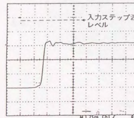
縦軸：5V/div 横軸：1.25ns/div (b) B 端出力電圧波形
