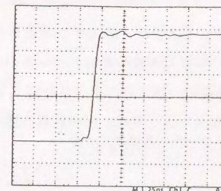
縦軸：5V/div 横軸：1.25ns/div (a) A 端電圧波形 (入力端電圧)
