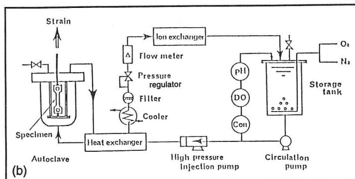
Fig. 2-1 SSRT apparatus
