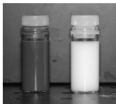
図 F-6. 異物として用いた墨汁と牛乳の混合液
