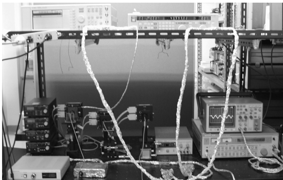
図 3.11 周波数領域拡散光の測定系の写真
