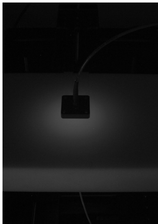
図 3.24 ポリアセタール内を伝搬してきた拡散光 (Olympus CAMEDIA E-10, F=2.4, Exposure time 2 sec, ISO-80) ただし、ポリアセタールに入射した光は 50 mW
