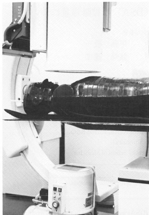
Fig. 1 Humanoid phantom. Model RT-200
