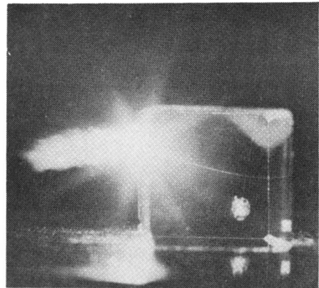
第6-4図 バリウムクラウンガラスの表面上に発生したプラズマの静止写真 (出口)
