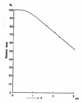
横軸に打抜の半径をとり縦軸に打抜照射をしない場合の中心の線量を 100%とした相対線量を示した. 図中実線は (1)式による計算の結果で○印が測定した結果である.
