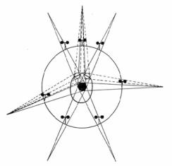
このようにして回転照射を行うと、打抜ブロックは被照射体の打抜部位に対し常に線束の影をつくり、その影の部分は他の部位に対し照射される線量は少くなる.この原理を図2に示す.
