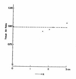
打抜ブロックを使用しない場合の Tissue-Air-Ratioの測定値は計算値と一致した. それに対し、 打抜照射の場合の測定した結果は多少の差があるがこの値は計算値に対し±1.25%の差であつた. この結果を図10に示す. 図は横軸に眼球打抜範囲の半径をとり、縦軸に Tissue-Air-Ratio をとつたものである. 破線で示したのは打抜照射をしない場合の Tissue-Air-Ratio の計算値である.
