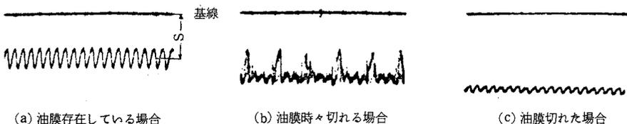
図 3-7 油膜厚さ測定時の波形
