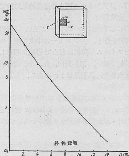
照射野を平行移動させ 照射野縁と測定部との距離を變へた時の散亂線量の變化を見た。
