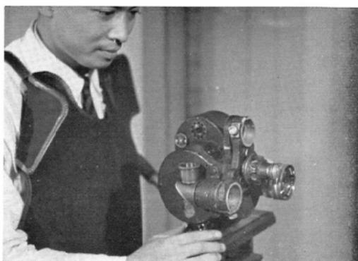
ンズは超大口径レンズで高価、かつ入手困難である関係上、研究当初において国産品として唯一の大口径 Zunow レンズを使用した。一般に35mmフィルム用撮影標準レンズの焦点距離は35mmで、したがつて Zunow レンズは望遠レンズに属する(表3)。
