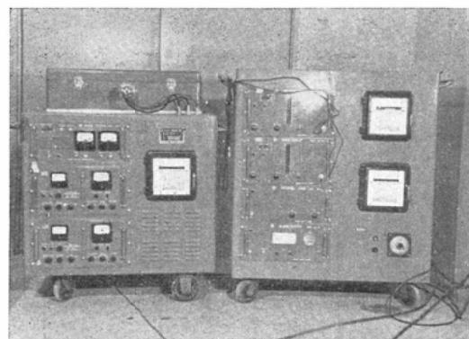
MDS-2型ダストモニター (第2図) を用い、濾紙を通じて一定量の空気を吸引し、濾紙上に捕捉された放射能を測定して、空気中のウラン濃度を求める方法である。塵埃の放つ放射線のうち、 $\beta, \gamma$  線は GM 管で捕捉直後測定し、 $\alpha$  線は捕捉 7 時間後  $\alpha$  線用シンチレーションプローブにより測定し、いずれもレートメーターで自記記録させる。7 時間後  $\alpha$  線を測定するのは、大気中から捕捉されたラドン及びその娘核種の減衰をまつて測定し、精度を高めるためである。
