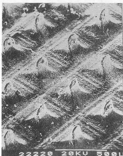
図3.25 ワイヤカット放電加工によるマイクロピン
