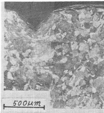
(h) くさび角 2\theta = 90^\circ 銅焼鈍材
