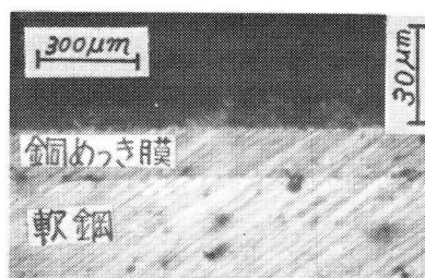
図5・2 銅めっき膜の斜め切断面
