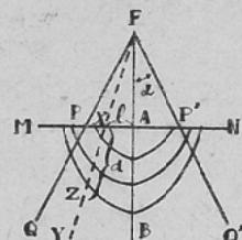
第2圖の如き等量曲線圖に於て、Fをエツクス線管焦点の位置、一次エツクス線束の限界をFPQ及びFP'Q' としP及びP'をファントーム平面
