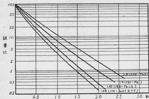
ている場合、その壁が取締規則に従った鉛當量しか入っていない時は、第2圖のW曲線に示す如く5%となり、線量はその場所に毎分0.5r出ているれば0.025r/mの多きに達し非常に危険である。従つて管球の使用方向は特に注意せねばならぬ。
