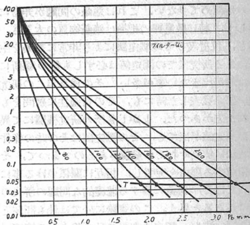
今診療用X線装置取締規則第2條に規定された利用線錐以外のX線遮蔽鉛當量をこの表に書き入れると、治療の場合はT曲線となる。この曲線に示す如く電壓の高い程透過線量はやゝ少くなつてゐるが、これは電壓が高い程透過率が高くなると
