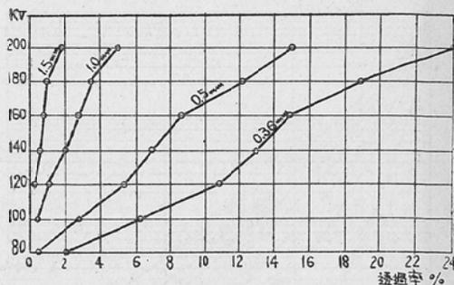
表に見る如く1.0mmpbを用いたる場合には、180KV迄は透過X線の上昇は殆んど直線を示し、180KV以上になると急に上昇する。1.5mmpb、0.3mmpbの時は120KV迄は急で、それ以上180KV迄は曲線は稍と緩慢に上昇し、180KVを越すと急激に上昇することが判る。即ち180KV以上の電圧になると、そのX線の遮蔽に必要な鉛當量が急激に増加する。又 Grebe-Mitzge の表よりみて電圧の上昇に比して、深部線量の増加は180KV以上になると、それ程増加しない事が知られている。従つて遮蔽の面よりみても、又電圧と深部線量の割合から考えても、深部治療装置は、その遮蔽と絶縁に製作上の困難を伴う200KV以上の高電圧X線治療装置よりも、180KV前後の装置が却つて能率的であり、合理的であると思われる。
