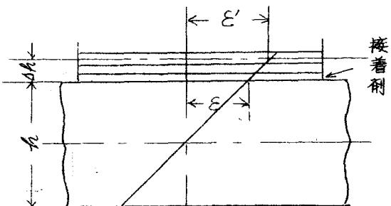
図 5.8 ひずみケージの厚さによる修正
