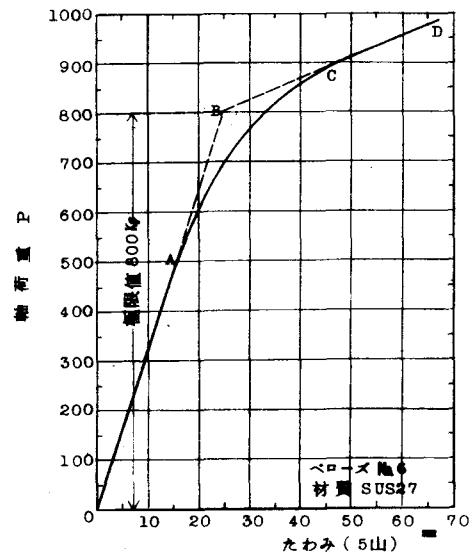
図 5.7 ステンレス鋼製ベローズの荷重-たわみ曲線
