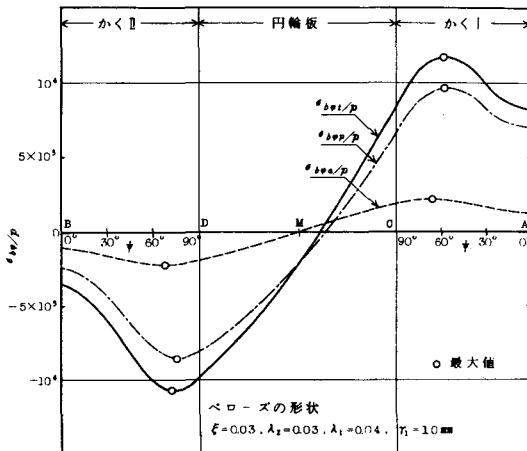
図 6.5 応力分布 ( $\sigma_e/\sigma_p = 1/2$  の場合)
