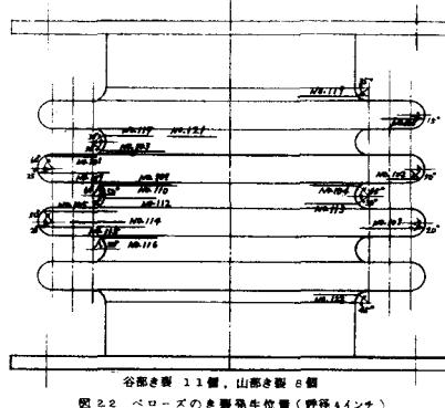
図 2.2 ベローズのき裂発生位置(呼径 4インチ)
