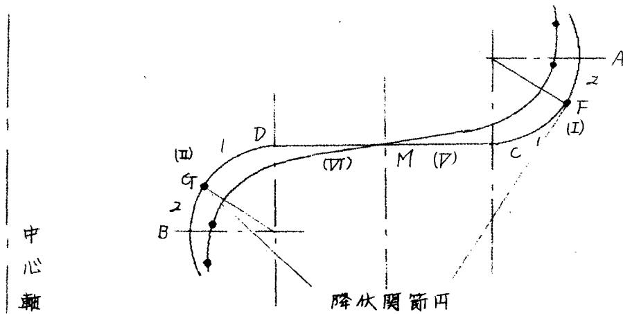
図5.2 U形ペローズの変形機構
