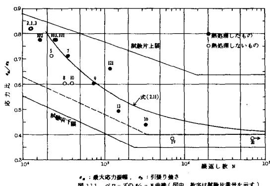
(SUS 27) の引張り強さは、実験の結果  $\sigma_B = 71 \text{ kg/mm}^2$  であるから、ベローズに種々の変位振幅を与えたときの最大応力値を第1編の計算図表を用いて計算すると、応力比  $\sigma_a/\sigma_B$  が求められる。ここで総変位から 1 ピッチ当りの変位を求めるべき問題になるのはベローズの両端の山である。通常ベローズの両端の山はフランジに密接されているので全長の変位は 1 山の変位に山数を乗じたものより小さく、全長の変位と 1 山の変位との割合を測定した実験結果によると、両端の 1 山はほぼ 0.65 山の役割しか果していなうことわかる。したがつてこの実験に用いたベローズは 4 山であるから、有効山数は 3.3 となる。1 山 (ピッチ) 当りの変位を  $\delta_t$  とすると、第1編の計算図表から最大応力  $\sigma_{gm}^{(II)}$  は
