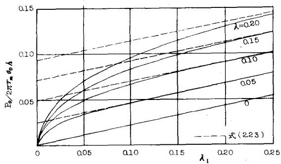
図 3.3 C形ペローズの極限軸荷重
