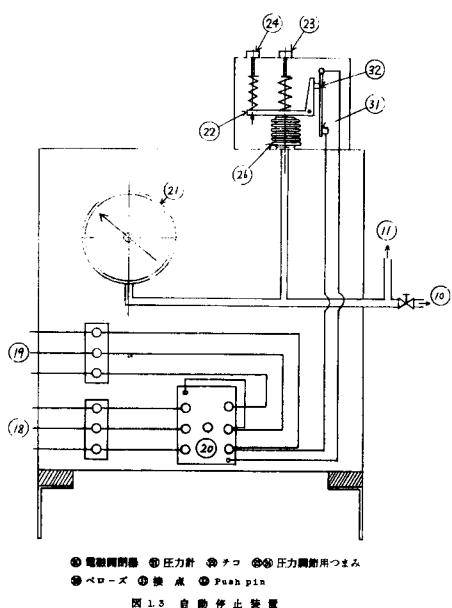
⑦が閉じて、電磁開閉機⑯の電磁石に電流が流れ、開閉機を開じる状態になる。ここでスイッチ⑯を押してモータを起動させる。この状態で試験を継続し、試験用ベローズにき裂が入り、中の空気がもれてあらかじめセットしておいた圧力よりも下がると、ベローズ⑮が軸方向に縮み push pin⑰を押さなくなるので、接点⑯は離れ電磁開閉機⑯を開き、モータへの電流をしゃ断することになる。なお起動および停止の圧力はつまみ⑲および⑳を調節することによって起動圧力は0～3.5kg/cm<sup>2</sup>まで停止圧力は0～3.5kg/cm<sup>2</sup>まで変えることができる。
