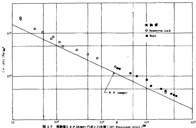
図2.5 実験値と B.F.Langer の式との比較 (347 Stainless steel)<sup>(38)</sup>
