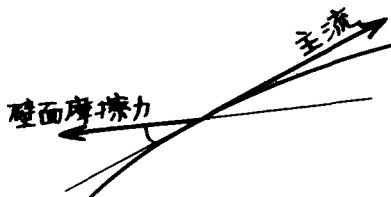
図 5.5 主流の向きと壁面摩擦力のくい違い
