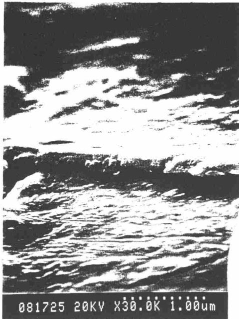
図 5-17 ポリイミド基板上に形成した PLT 薄膜の断面 SEM 像
