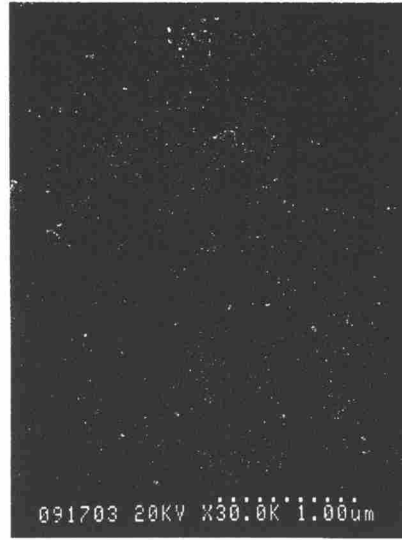
図 5-9 Pt/MgO 基板上に形成した PLT 薄膜の (a) エキシマレーザ未照射領域、および (b)照射領域の表面 SEM 像
