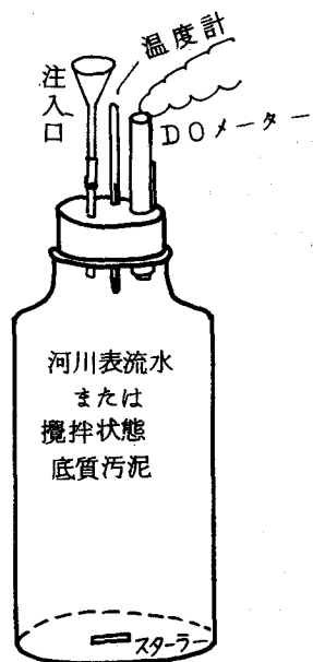
図 2 - 1 河川水の酸素消費速度測定装置
