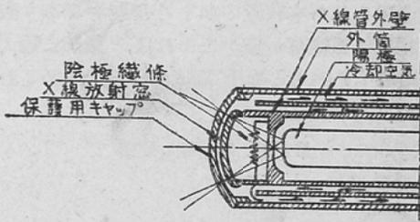
本装置 X 線管先端部構造(島津時報より)
