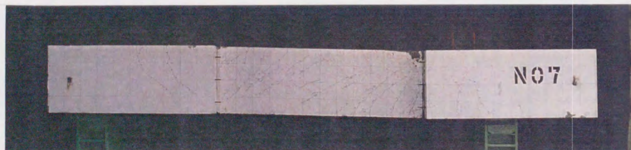
試験体名 L7SP (突合せ継手, PCa柱試験体) 試験体の概要 b600 \times D600 \times h01850(\text{mm}) , pg=2.14\% , pg'=0.96\% , pw=2.03\% \sigma_B=315\text{kgf/cm}^2 , \sigma_B'=621\text{kgf/cm}^2 , N/(bDFc)=0.167
