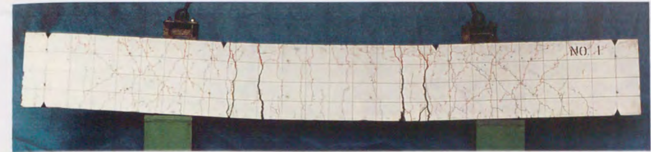
試験体名 LBR1 試験体の概要 b350 \times D640 \times h01800(\text{mm}) , pg=1.71\% , pw=1.78\% , \sigma_B=248\text{kgf/cm}^2 主筋重ね継手長さ25d, 添え筋余長(片側)175mm
