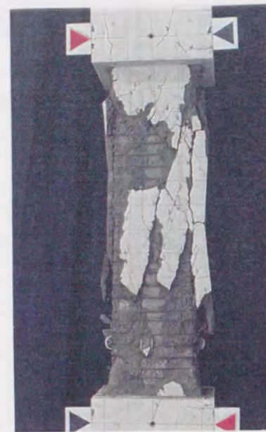
試験体 II 3-14PA b \times D \times h_0 (mm); 400×400×1600 p_g=2.90\% p_w=0.80\% \sigma_B=627\text{kgf/cm}^2 \sigma_B'=915\text{kgf/cm}^2 N/(bDF_c)=0.5 AタイプPCa
