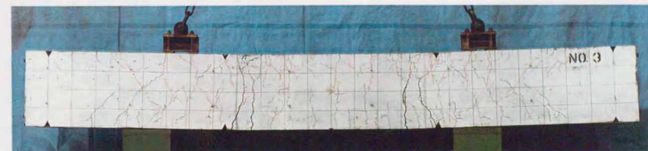
試験体名 LBR3 試験体の概要 b350 \times D640 \times h01800(\text{mm}) , pg=1.71\% , pw=1.78\% , \sigma_B=244\text{kgf/cm}^2 主筋重ね継手長さ30d, 添え筋余長(片側)175mm
