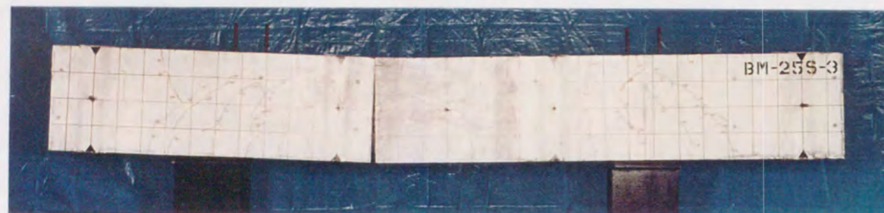
試験体名 LB5 試験体の概要 b640 \times D640 \times h01300(\text{mm}) , (外殻PCa使用) pg=2.8\% , pw=1.41\% , \sigma B=250\text{kgf/cm}^2 , 主筋重ね継手長さ25d
