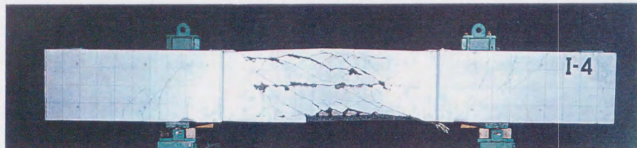
試験体名 II 1-4PA (AタイプPCa使用) 試験体の概要 b600 \times D600 \times h01850(\text{mm}) , pg=3.2\% , pw=0.71\% (コア) \sigma_B=196\text{kgf/cm}^2 , (外殻) \sigma_B'=675\text{kgf/cm}^2
