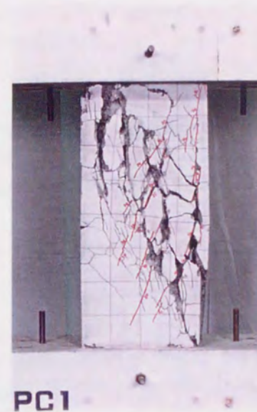
試験体Ⅱ2-5PA b \times D \times h_0 (mm) ; 350×350×800 pg=1.87\% pw=1.45\% \sigma B=459\text{kgf/cm}^2 \sigma B'=584\text{kgf/cm}^2 N/(bDFc)=0.55 AタイプPCa
