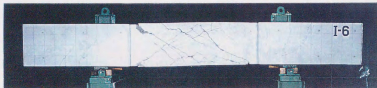
試験体名 II 1-6R (在来工法, 一体打ち) 試験体の概要 b600 \times D600 \times h01850(\text{mm}) , pg=3.2\% , pw=0.71\% \sigma_B=196\text{kgf/cm}^2
