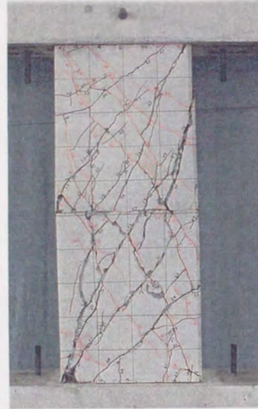
試験体 II 3-8PA2 b \times D \times h_0 (mm) ; 400×400×1000 pg=1.40\% pw=0.30\% \sigma B=301\text{kgf/cm}^2 \sigma B'=823\text{kgf/cm}^2 N/(bDFc)=0 AタイプPCa 2本継ぎ
