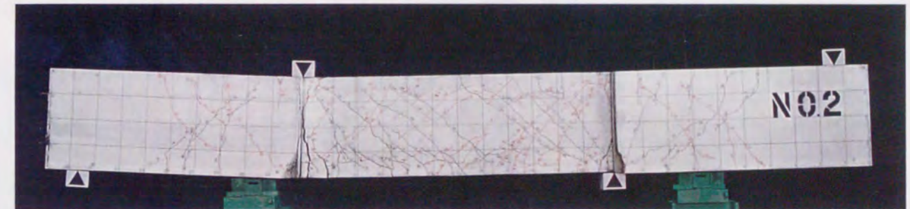
試験体名 L2SR (突合せ継手, RC柱試験体) 試験体の概要 b600 \times D600 \times h01850(\text{mm}) , pg=2.12\% , pg'=0.96\% , pw=1.33\% \sigma B=207\text{kgf/cm}^2 , N/(bDFc)=0
