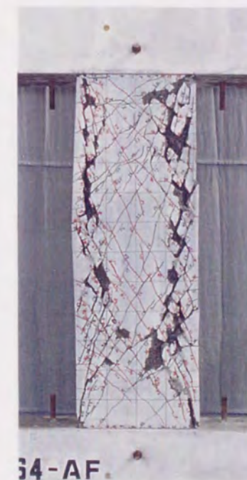
写真4.2 シリーズⅢ-2 (突合せ小型試験体) 試験体破壊状況 (その1)
