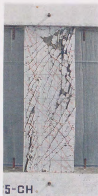
試験体S6SP b \times D \times h_0 (mm) ; 400×400×1200 p_g=2.54\% p_g'=1.00\% p_w=0.85\% \sigma_B=285\text{kgf/cm}^2 \sigma_B'=562\text{kgf/cm}^2 N=-0.2Ag \sigma_y \sim bDFc/3 突合せPCa柱
