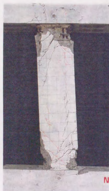
写真3.4 シリーズⅡ-2 試験体破壊状況 (その1)
