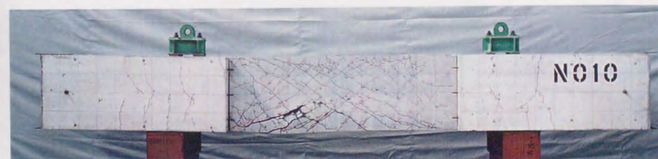
試験体名 L10SP (突合せ継手, PCa柱試験体) 試験体の概要 b600 \times D600 \times h01850(\text{mm}) , pg=2.12\% , pg'=0.97\% , pw=0.53\% \sigma_B=323\text{kgf/cm}^2 , \sigma_B'=524\text{kgf/cm}^2 , N/(bDFc)=0
