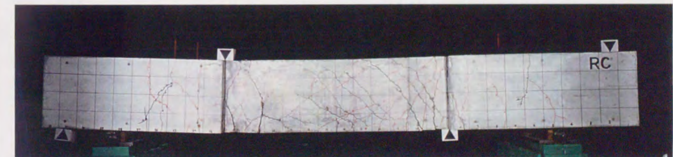
試験体名 II-1-3R (在来工法、一体打ち) 試験体の概要 b600 \times D600 \times h01850(\text{mm}) , p_g=1.8\% , p_w=1.33\% \sigma_B=181\text{kgf/cm}^2
