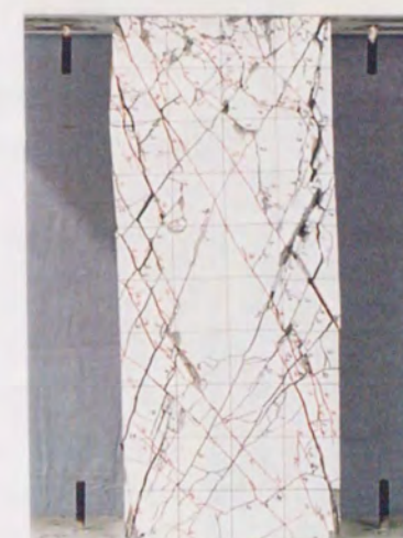
試験体 II 3-11PA b \times D \times h_0 (mm) ; 400×400×1000 pg=1.40\% pw=0.17\% \sigma B=240\text{kgf/cm}^2 \sigma B'=773\text{kgf/cm}^2 N/(bDFc)=0.125 AタイプPCa
