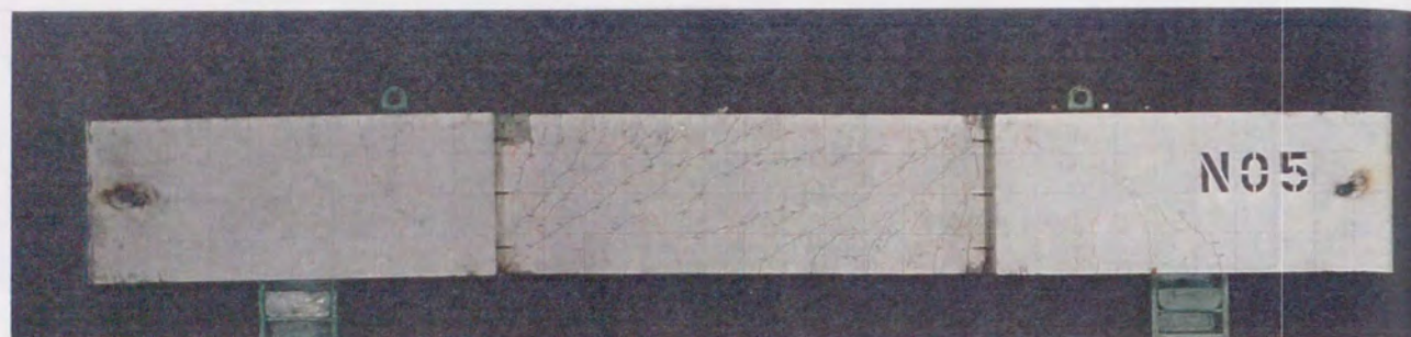
試験体名 L5SR (突合せ継手, RC柱試験体) 試験体の概要 b600 \times D600 \times h01850(\text{mm}) , pg=2.14\% , pg'=0.96\% , pw=2.03\% \sigma_B=276\text{kgf/cm}^2 , N/(bDFc)=0.167
