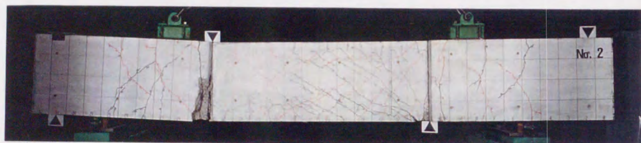
試験体名 LSR2 試験体の概要 b600 \times D680 \times h01800(\text{mm}) , pg=1.6\% , pw=0.61\% , \sigma B=237\text{kgf/cm}^2 主筋重ね継手長さ25d, 添え筋余長(片側)525mm
