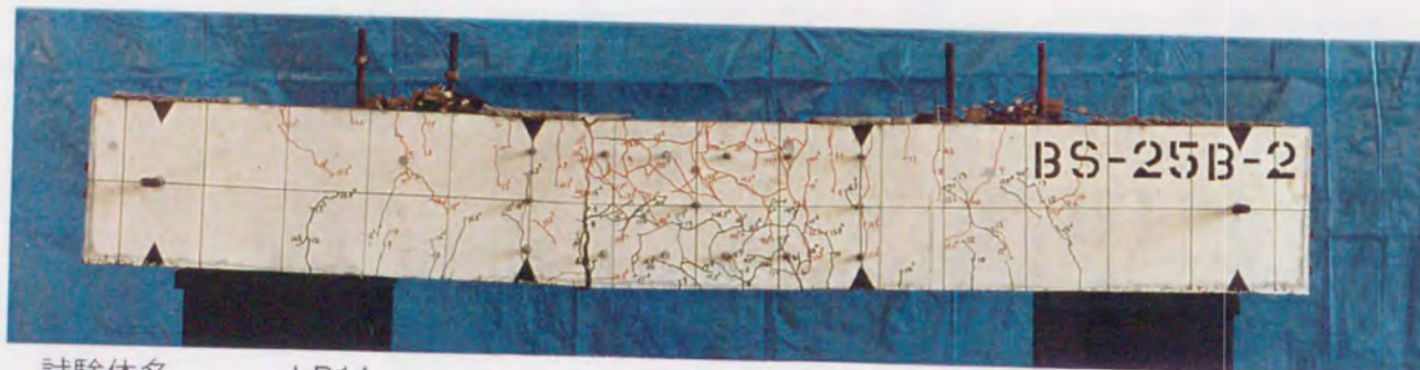
試験体名 LB14 試験体の概要 b250 \times D250 \times h600(\text{mm}) p_g=2.8\% , p_w=0.64\% , \sigma_B=263\text{kgf/cm}^2 , 主筋重ね継手長さ25d
