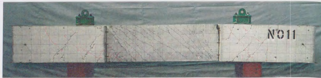
試験体名 L11SP (突合せ継手, PCa柱試験体) 試験体の概要 b600 \times D600 \times h01850(\text{mm}) , pg=2.12\% , pg'=0.97\% , pw=1.00\% \sigma B=330\text{kgf/cm}^2 , \sigma B'=524\text{kgf/cm}^2 , N/(bDFc)=0
