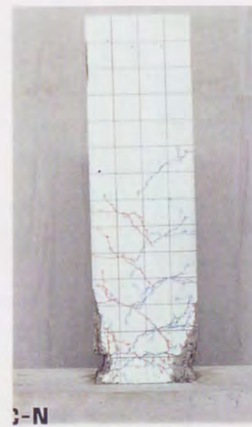
写真5.3 シリーズIV (繰返し載荷実験) 試験体破壊状況
