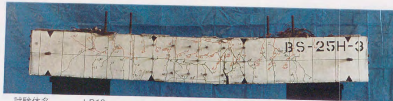
試験体名 LB13 試験体の概要 b350 \times D350 \times h600(\text{mm}) p_g=2.8\% , p_w=1.45\% , \sigma_B=257\text{kgf/cm}^2 , 主筋重ね継手長さ25d
