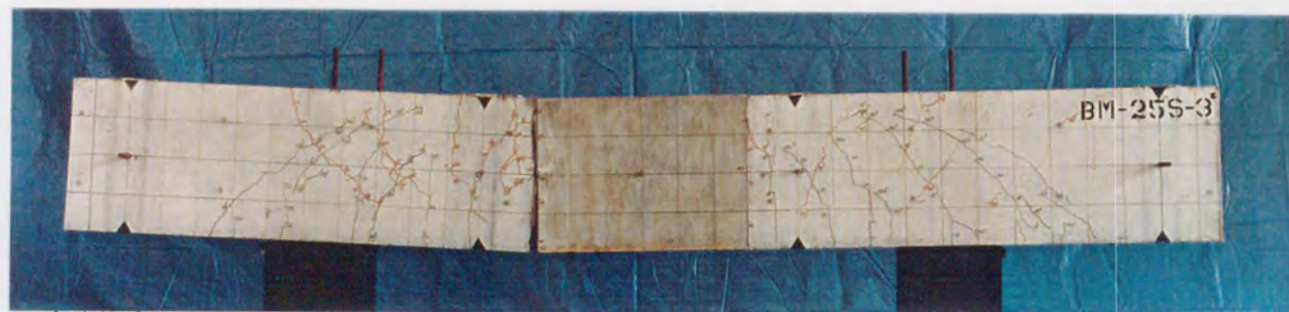
試験体名 LB6 試験体の概要 b640 \times D640 \times h01300(\text{mm}) , (鉄板外周巻付け) pg=2.8\% , pw=1.41\% , \sigma B=233\text{kgf/cm}^2 , 主筋重ね継手長さ25d
