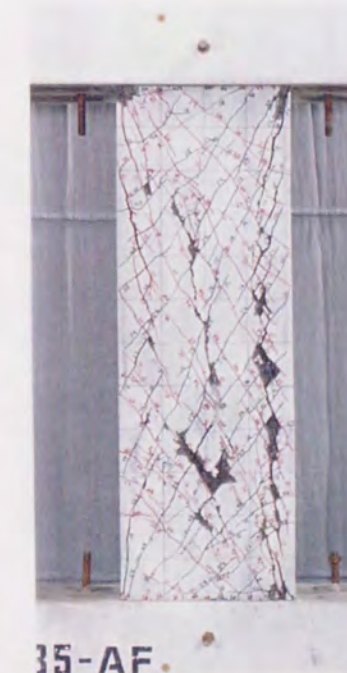
写真4.2 シリーズⅢ-2 (突合せ小型試験体) 試験体破壊状況 (その1)
