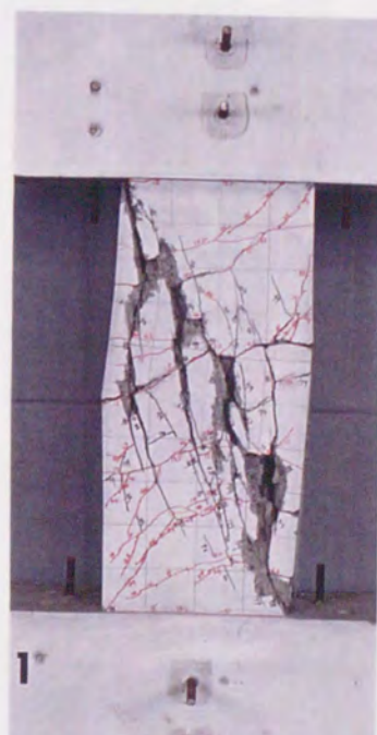
試験体S12NR b \times D \times h_0 (mm) ; 400×400×1000 p_g=2.54\% p_w=1.00\% \sigma_B=436\text{kgf/cm}^2 N=-0.5Ag \sigma_y \sim 0.6bDFc 継手なし 一体打ち柱
