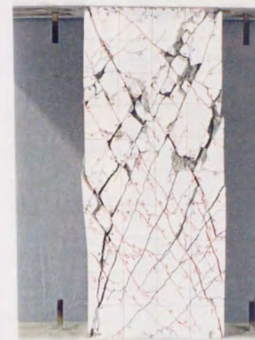
試験体 II 3-10PA b \times D \times h_0 (mm) ; 400×400×1000 pg=1.40\% pw=0.30\% \sigma B=240\text{kgf/cm}^2 \sigma B'=773\text{kgf/cm}^2 N/(bDFc)=0.125 AタイプPCa
