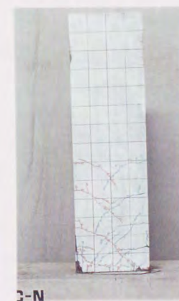
写真5.3 シリーズIV (繰返し載荷実験) 試験体破壊状況
