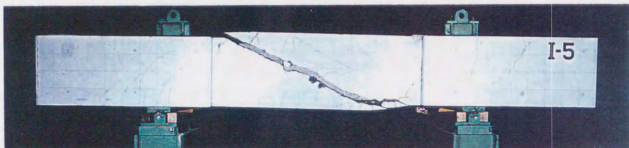
試験体名 II 1-5PB (BタイプPCa使用) 試験体の概要 b600 \times D600 \times h01850(\text{mm}) , pg=3.2\% , pw=0.71\% (コア) \sigma_B=196\text{kgf/cm}^2 , (外殻) \sigma_B'=675\text{kgf/cm}^2
