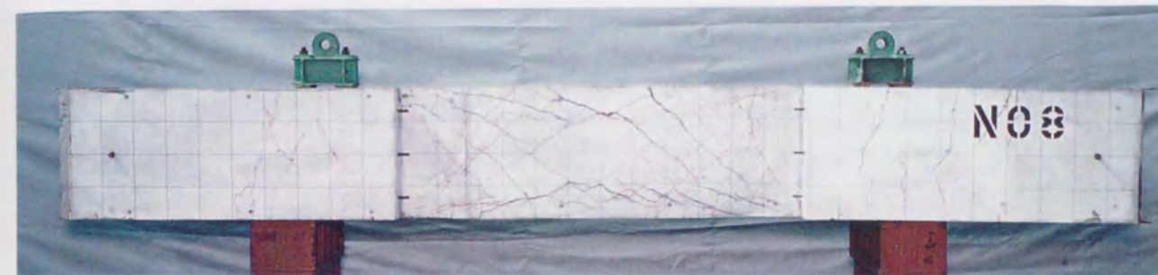
試験体名 L8SR (突合せ継手, RC柱試験体) 試験体の概要 b600 \times D600 \times h01850(\text{mm}) , pg=2.12\% , pg'=0.97\% , pw=0.83\% \sigma_B=295\text{kgf/cm}^2 , N/(bDFc)=0
