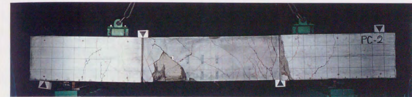
試験体名 II-1-2PA (AタイプPCa使用) 試験体の概要 b600 \times D600 \times h01850(\text{mm}) , p_g=1.8\% , p_w=1.33\% (コア) \sigma_B=181\text{kgf/cm}^2 , (外殻) \sigma_B'=579\text{kgf/cm}^2
