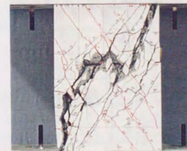
試験体 II 3-12PA b \times D \times h_0 (mm) ; 400×400×600 pg=1.40\% pw=0.30\% \sigma B=240\text{kgf/cm}^2 \sigma B'=773\text{kgf/cm}^2 N/(bDFc)=0.25 AタイプPCa
