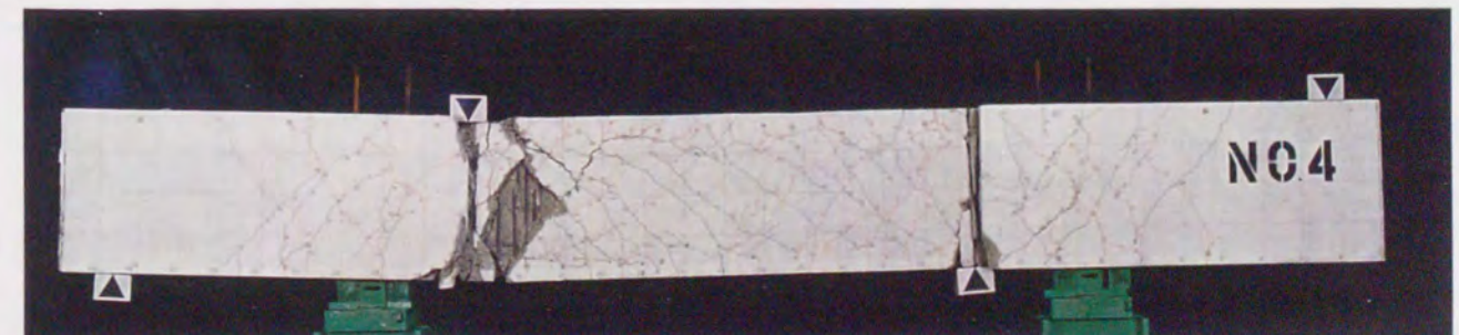
試験体名 L4SR (突合せ継手, RC柱試験体) 試験体の概要 b600 \times D600 \times h01850(\text{mm}) , pg=2.12\% , pg'=0.96\% , pw=2.03\% \sigma B=233\text{kgf/cm}^2 , N/(bDFc)=0
