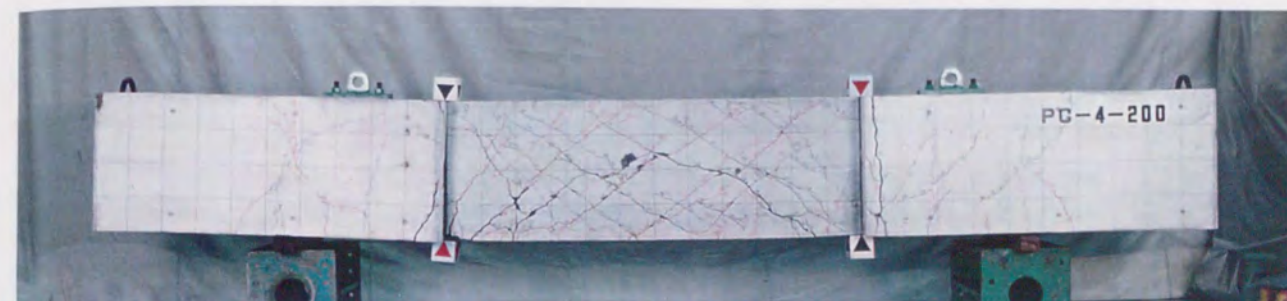
試験体名 II 1-7PA (AタイプPCa使用) 試験体の概要 b600 \times D600 \times h01800(\text{mm}) , pg=1.4\% , pw=0.42\% (コア) \sigma_B=302\text{kgf/cm}^2 , (外殻) \sigma_B'=584\text{kgf/cm}^2
