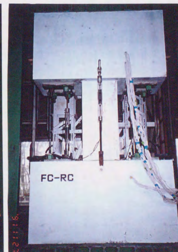
軸方向変位の測定 (中央と左右の3ヶ所)
