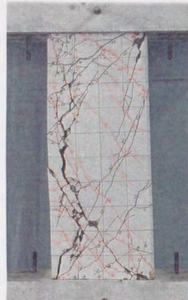
試験体 II 3-7PA b \times D \times h_0 (mm) ; 400×400×1000 pg=1.40\% pw=0.30\% \sigma B=301\text{kgf/cm}^2 \sigma B'=823\text{kgf/cm}^2 N/(bDFc)=0 AタイプPCa
