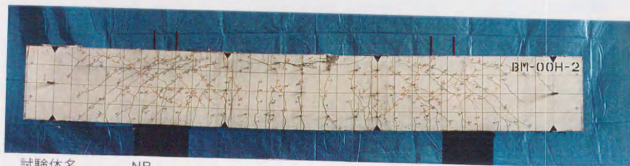
試験体名 NB 試験体の概要 b640 \times D640 \times h1300(\text{mm}) p_g=2.8\% , p_w=0.79\% , \sigma_B=238\text{kgf/cm}^2 , 通し配筋
