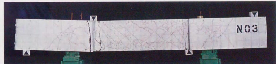
試験体名 L3SR (突合せ継手, RC柱試験体)
