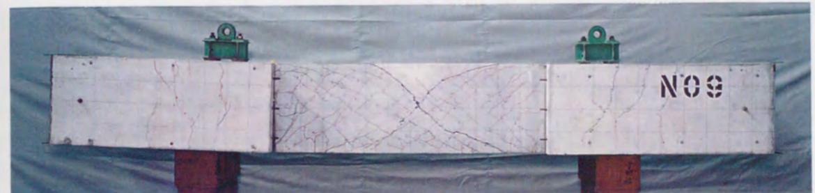
試験体名 L9SP (突合せ継手, PCa柱試験体)
