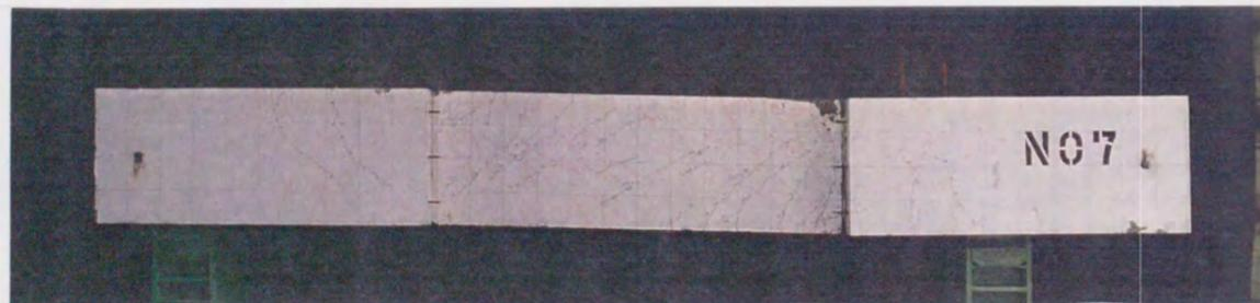
試験体名 L7SP (突合せ継手, PCa柱試験体)
