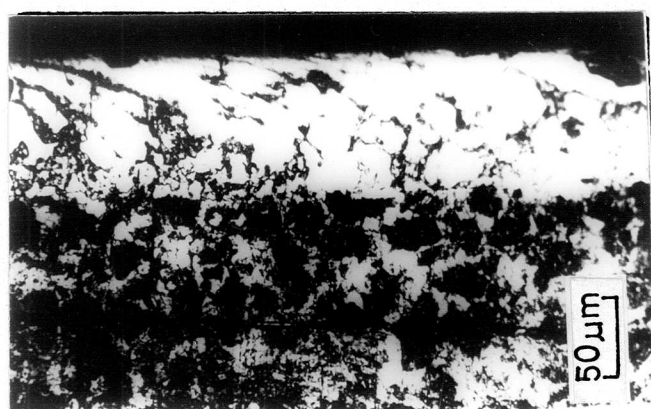
図3.19 研削加工表面下の組織の1例 (研削方向)
