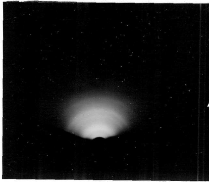
図6.13 純鉄研削面の電子線回折像の1例
