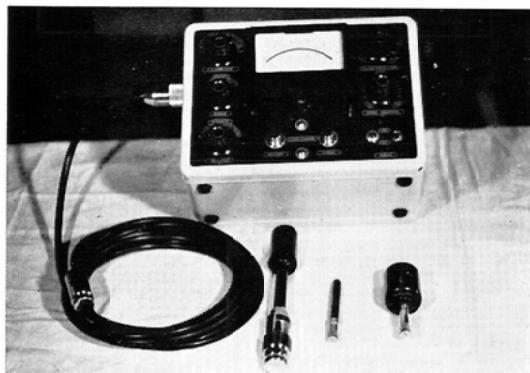
測定器と測定槽を第1図に示した。右から Bottle model, Fountain pen model, 及び Ionization Chamber である。
