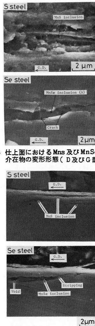
図 4-15 加工層における MnS 及び MnSe 介在物の変形 研削条件：図 4-13 と同じ
