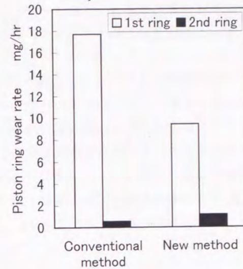
図 5.56 ピストンリング摩耗量計測結果
