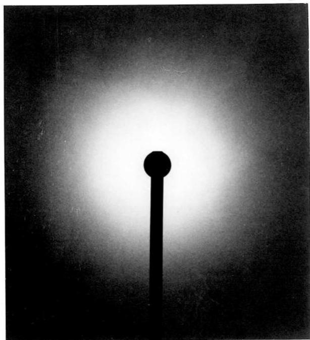
図4-4  $\text{La}_2\text{O}_3 \cdot 6\text{Al}_2\text{O}_3$  非晶質のX線ビンホール写真
