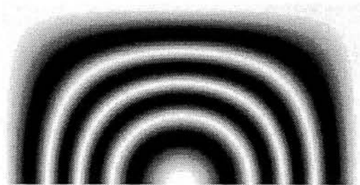
図 A10.5 位相シフト走査モアレ法によって得られた滑らかなモアレじま
