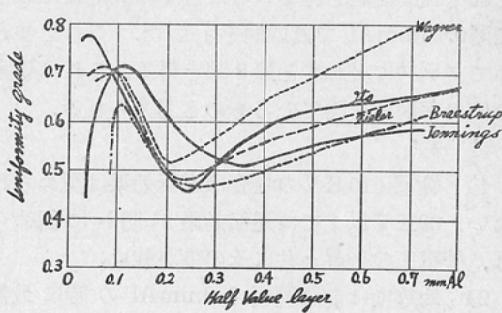
Al 吸収板, Siemens 線量計附属品を用いた。管電圧, 管電流は Step 1 乃至 4 の条件で, 但し何れも附加濾過板を除き, 前濾過板として 1 mm より 2 mm の醋酸セルローズ, 0.159 mm, 0.3 mm, 0.6 mm, 1.0 mm より 2.0 mm の Al を用い, 全測定について減弱曲線を作り第 1, 第 2 半価層を求めて均等度 =  $\frac{\text{第1半価層}}{\text{第2半価層}}$  を決定した。
