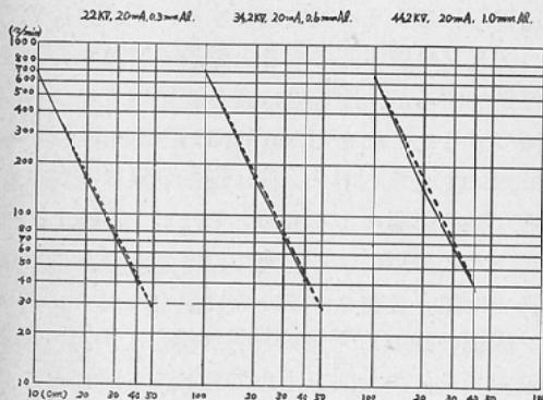
りで、これを対数方眼紙で第4図にグラフで表わす。これらの軟X線では空気による認むべき吸収が測定距離20cm乃至40cmの間ではない。各距離の測定値と逆2乗の法則からの計算値と大体一致している。
