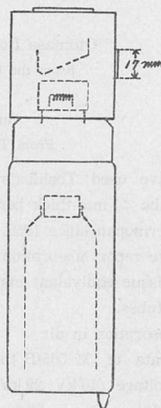
る。陽極はタンクスチルで傾斜角は20°である。最高使用電圧50kVp、最大許容電流25mA連続である。亦M505/Bは国産で初めてのBe窓管でその有効窓の径は17mmで放射窓は1mm厚のベリリウムで出来ており、ターゲット角度20度、X線放射角は主放射方向を中心軸とし焦点を頂点として約35°の頂角を持つ円錐内である。その概要は第1図に示す通りである。管電圧、許容管電流はM5057A管と同様である。線量計としてSiemensのSoft Chamber, Phantom Chamberを用いた。Al半価層測定用として東芝および科研製のAl吸収板を用いた。皮膚等価物質として酢酸セルローズおよびポリステレンの薄板を使用した。
