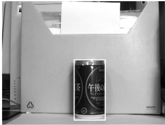
図 2.7: 抽出された物体の輪郭 (白線)
