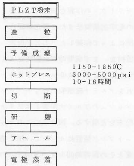
図 2.6 PLZT透明セラミックスの作製工程図
