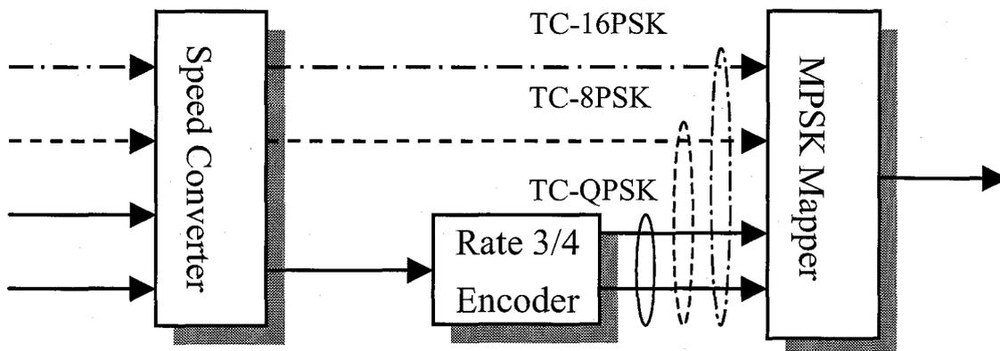
図 2.7 シンボルレート可変 Pragmatic TC-2<sup>m</sup>PSK の構成 (r=3/4)
