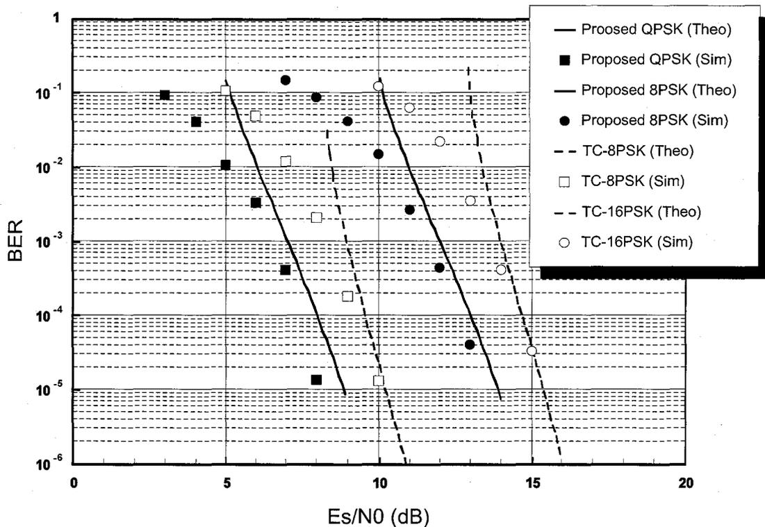
図 2.14 シンボルレート可変 TCM と従来の Pragmatic TCM の特性比較
