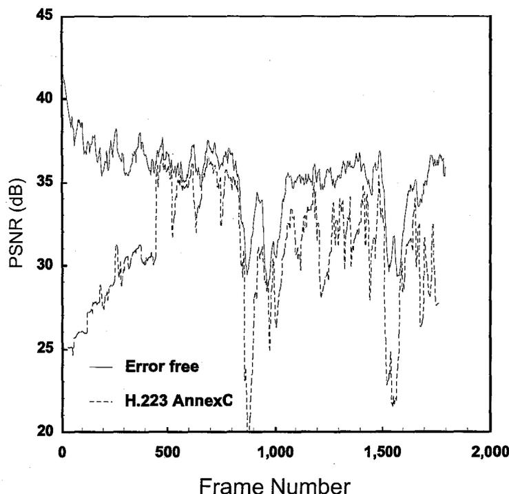
図 4.11 H.223 Annex C の PSNR (符号化レート 26kbps,  $E_b / N_0 = 16\text{dB}$ )
