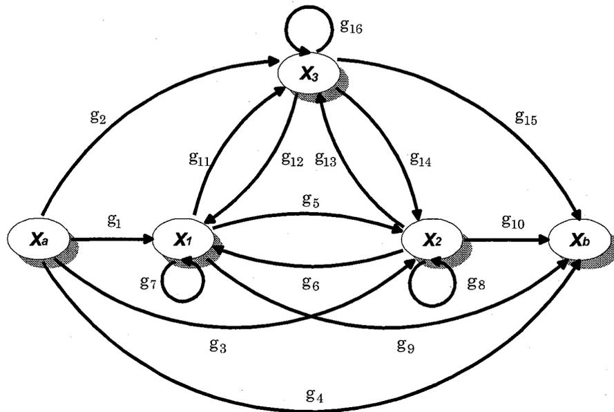
図 2.8 error-state diagram ( $r=3/4, K=3$ )
