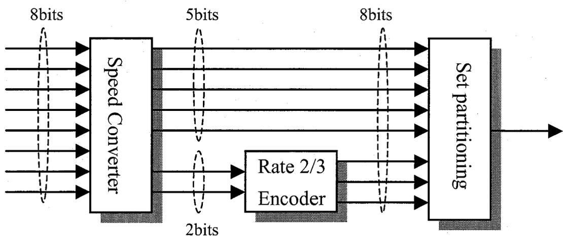
図 2.3 SRI-TCM の 256QAM への応用例
