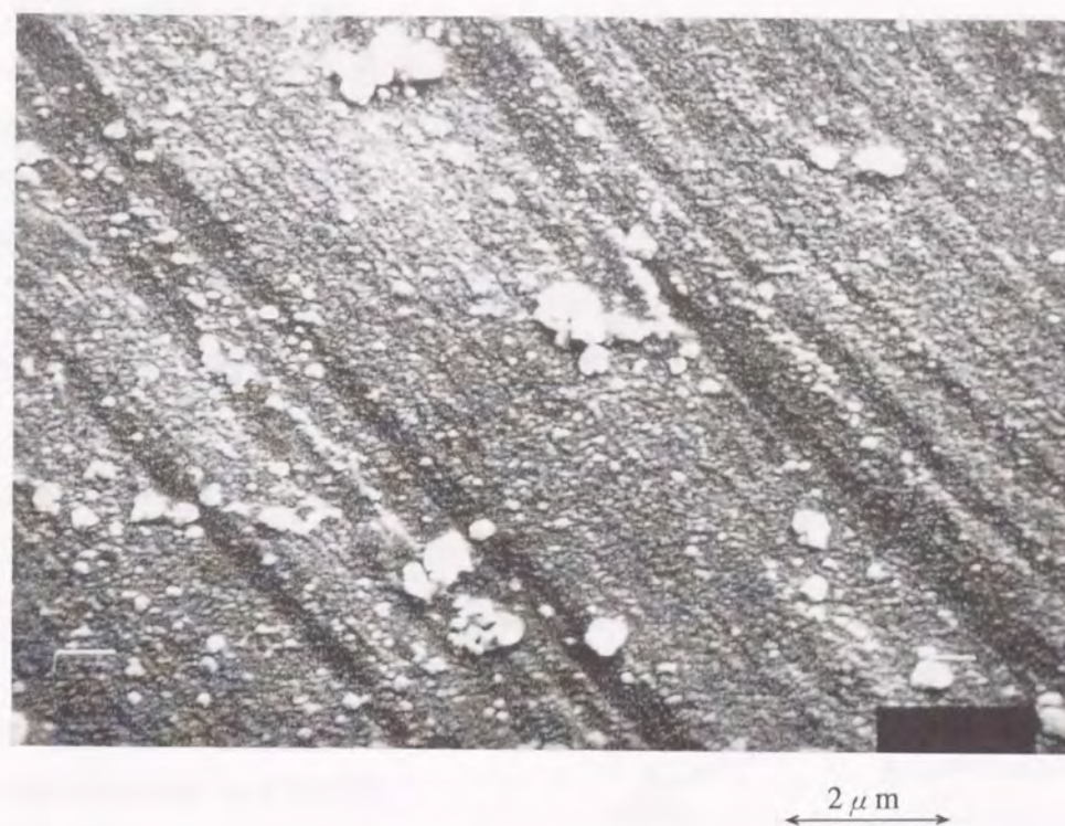
図4.18 延伸したPTフィルムの表面形態(SEM写真)
