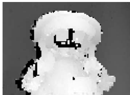
図 2.3: ブロックマッチングによる初期視差分布 (左画像基準)
